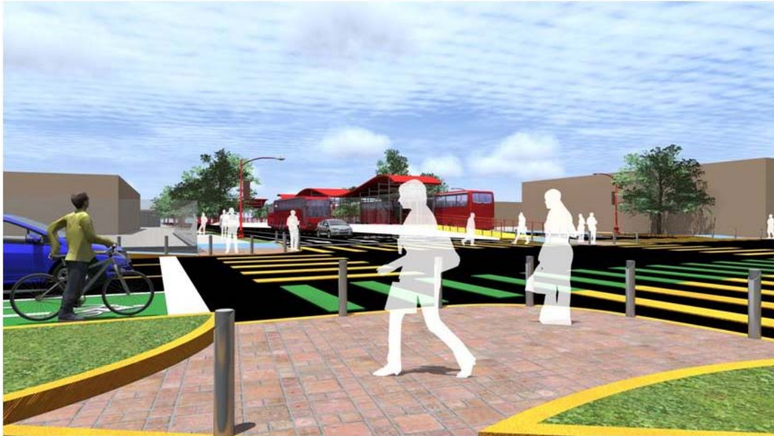
Figura 4.128. Solución de trayectos ciclistas y peatonales en esquinas
